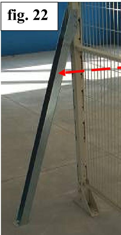
Per dare al montante una resistenza maggiore alla spinta laterale e più consistenza, si può montare come opzione il **supporto per montante** Fissato in basso con un **tappo da muro m8** In alto con **2 viti m6x50 con dado** regolabile tramite le viti sulle asole
