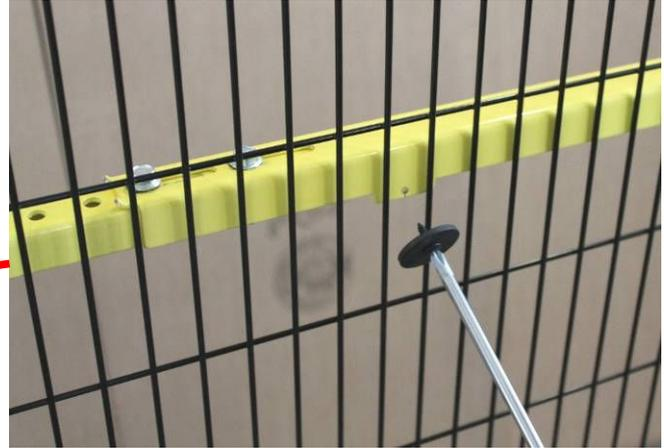
Avvitare una vite auto filettante con rondella (in dotazione) nel foro predisposto sul tirante centrale del lato esterno della protezione
